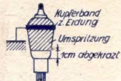
Abb. 12. Da bei den deutschen Röhren der Metallbelag unmittelbar mit der Kathode verbunden ist, muß er bei Verwendung dieser Röhren in Frequenzmessern oberhalb des Röhrenfußes auf etwa 1 cm abgekratzt werden. Durch ein herumgelegtes Band wird der Metallbelag dann gefordert geerdet.
